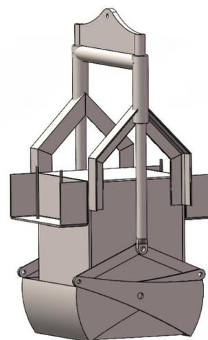
标准配置: 抓取系统、配重板、配置铅块、释放触发器组成。
